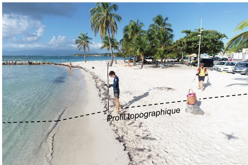
Illustration 4 - Mesure d'un profil topographique sur le site de la plage du Bourg de Sainte-Anne (profil de référence représenté en pointillé) (Moisan et al., 2023)
