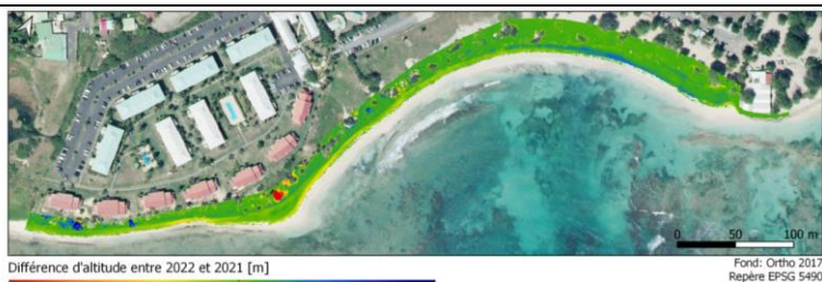
Illustration 11 - Différentiel altimétrique entre les levés photogrammétriques de 2022 et 2021 sur la plage de Raisin Clair en Guadeloupe (Moisan et al. 2023).
