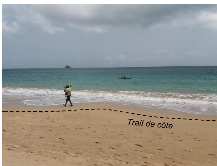
Illustration 3 - Levé de la position du trait de côte matérialisé par le jet de rive (limite entre la partie sèche et mouillée de la plage en pointillée) (Moisan et al., 2023)
