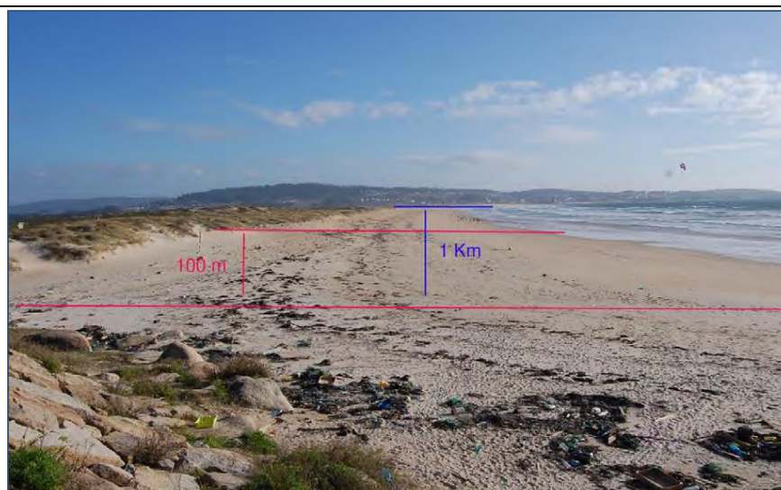
Illustration 1. Sections des 100 m et 1 km du protocole OSPAR (OSPAR, 2010)
