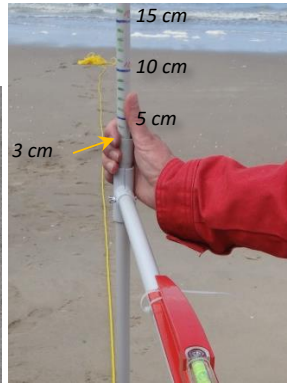
Sur le tube gradué de droite, on peut lire ici 3 cm (il ne reste que 2 graduations avant d'arriver à la marque bleue 5 cm)
